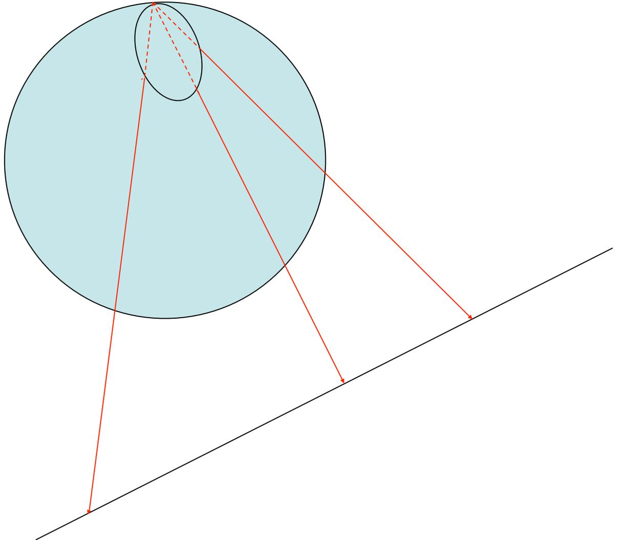
Si le cercle tracé sur la sphère n'est ni un méridien, ni un cercle parallèle au plan de l'écran, on parvient au résultat cherché en se servant du cône tangent à la sphère le long du cercle, également du théorème de Thalès.
